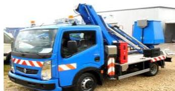
Type 3 : Haut de plancher  $\geq 9m$
